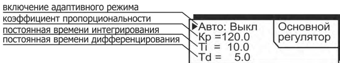
Рисунок 14 — Параметры ПИД-регулятора
