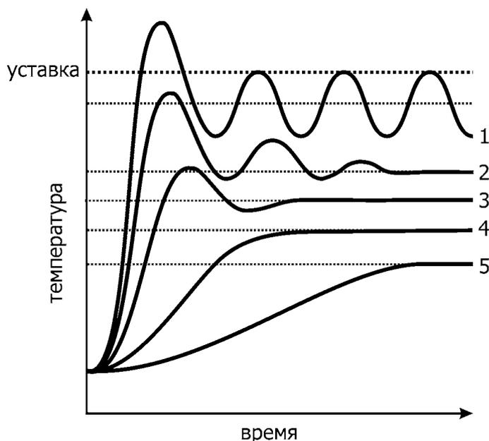
Рисунок 15 — Определение  $K_p$
