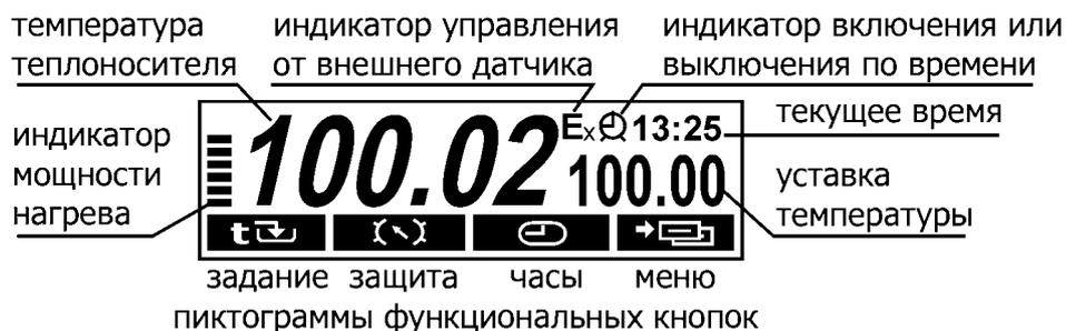
Рисунок 4 — Дисплей в режиме регулирования по уставке
